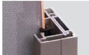
Grande résistance au vent grâce au guidage latéral contrôlé de la toile par une fermeture à glissière sur toute la hauteur de l'élément ; surface maxi : 18 m<sup>2</sup>
