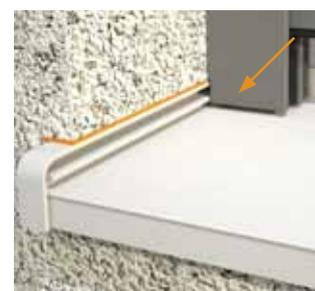
Coulisse avec entaille et 8 mm d'espacement par rapport à l'appui de fenêtre et l'embout de bavette pour le rattrapage de jeu.
