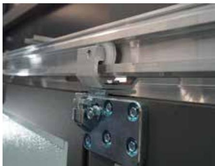
Un rail robuste en aluminium, associé à des chariots réglables en hauteur permettent un réglage optimal.
