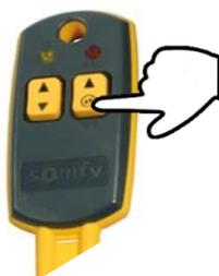
Appuyer sur la touche WT jusqu'à la mise en mouvement du volet roulant.
