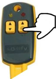
Appuyer sur la touche WT et rester appuyé jusqu'au deuxième bref mouvement du volet roulant.
