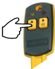
Faire un appui court (0,5 sec.) suivi d'un appui long sur la touche DESCENTE jusqu'à la mise en mouvement du volet roulant.
