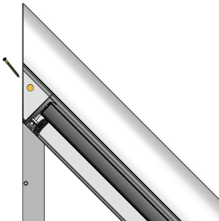
[DE] Bitte die Kastenzusatzbefestigung so weit oben wie möglich setzen. Wenn dies nicht oder schwer möglich ist, bei Montage auf die Laibung mittels mitgelieferten Zusatzmontagewinkel realisieren (->10.0) alternativ Variante 11.0.
